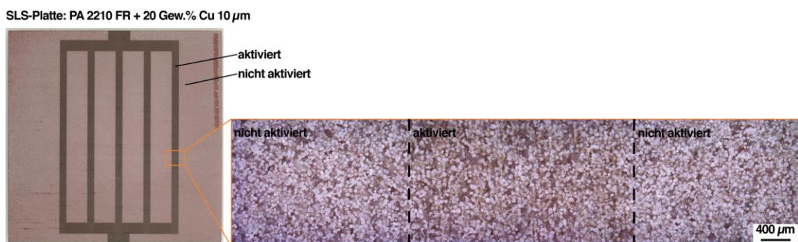
Abbildung 81 Photographie eines selektiv lasergesinterten Plattenprüfkörpers aus PA 2210 FR mit 20 Gew.% Kupferpulver in der Partikelgröße 10 \mu\text{m} mit aktivierten und nicht aktivierten Bereichen (links) und eine lichtmikroskopische Detailaufnahme der verschiedenen Bereiche (rechts). Das selektive Lasersintern und die Laserdirektstrukturierung des Prüfkörpers erfolgten durch [289].
