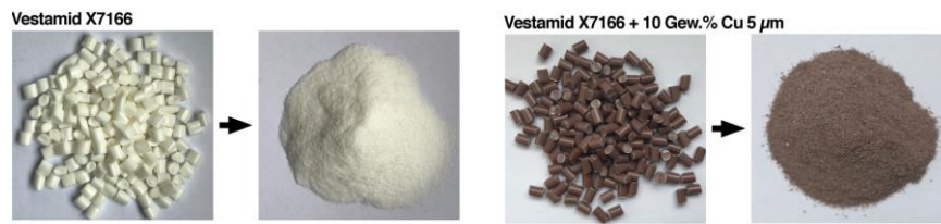
Abbildung 26 Ergebnis der kryogenen Mahlversuche an Vestamid X7166 und Vestamid X7166 mit 10 Gew.% Cu 5 µm.
