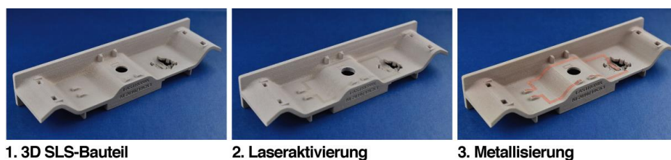
Abbildung 91 Darstellung der Verfahrensschritte SLS-Bauteil, Laseraktivierung und Metallisierung anhand des Anwendungsbeispiels 3D-Schaltungsträger [289, 308].
