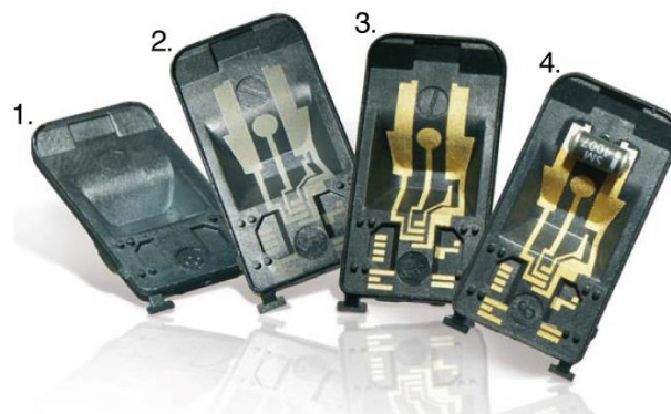
Abbildung 6 Prozessschritte beim LPKF-LDS ® -Verfahren: 1. Spritzgießen, 2. Laserstrukturierung, 3. Metallisierung und 4. Oberflächenveredelung nach [3, 4, 41] (Bildquelle: [3]).
