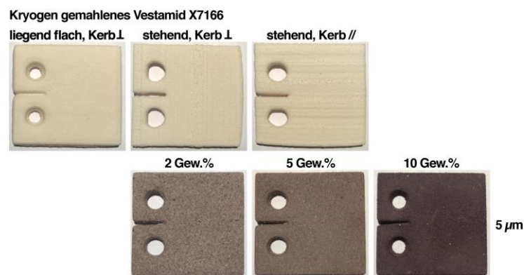
Abbildung 29 Übersicht der im selektiven Lasersinterprozess verarbeiteten Pulver-Verbunde auf Basis des kryogen gemahlene Vestamid X7166 anhand des Beispiels des CT-Prüfkörpers.
